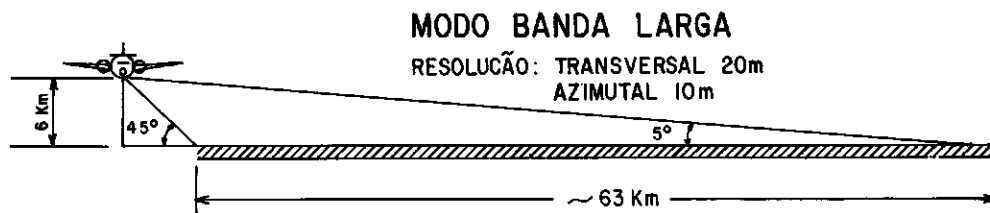
Figura 1. Geometria de aquisição do modo banda larga.
